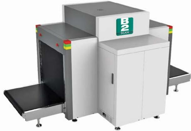
Две проекции проверяемого объекта отображаются каждая на отдельном мониторе, таким образом, опасные предметы и контрабанда, скрытые под перекрывающейся зоной будут обнаружены с большей вероятностью. Рентготелевизионная установка **B2scan 10080D** обладает функцией автоматического обнаружения взрывчатых и наркотических веществ.
